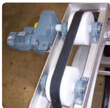
Entraînement et suspension du tambour par courroie poly V (Solution simple et robuste).
