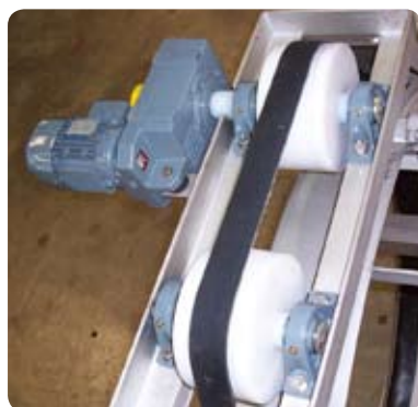
Entraînement et suspension du tambour par courroie poly V (Solution simple et robuste).
